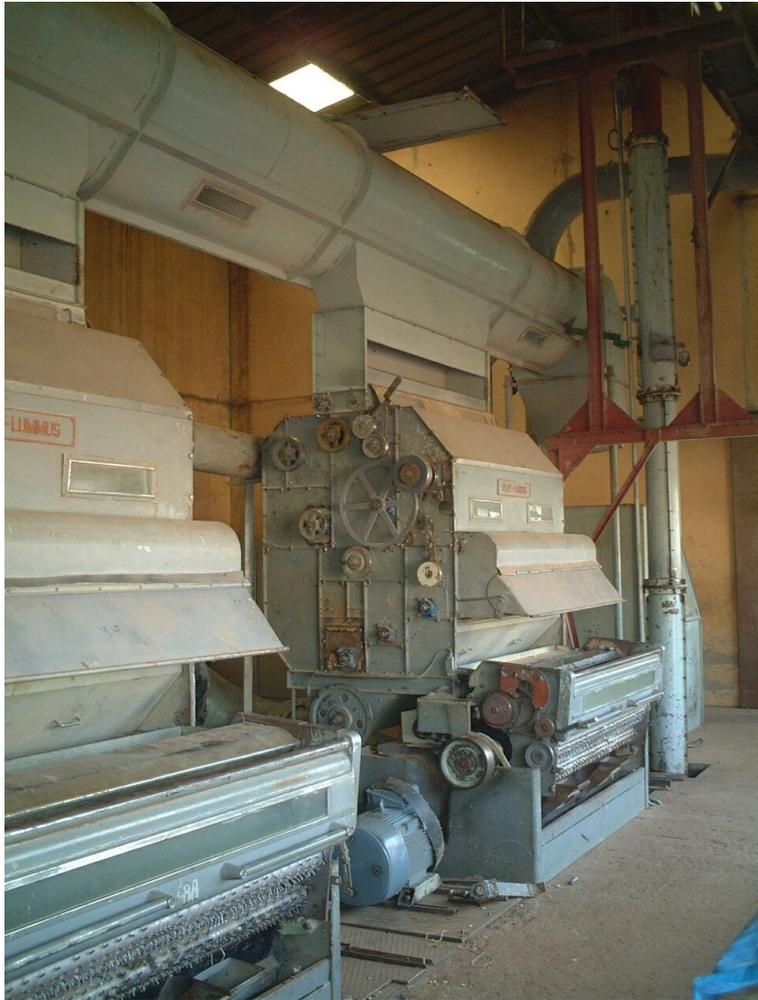
La sgranatura è un procedimento meccanico con il quale la fibra viene separata dai semi e, successivamente, pressata in balle.
